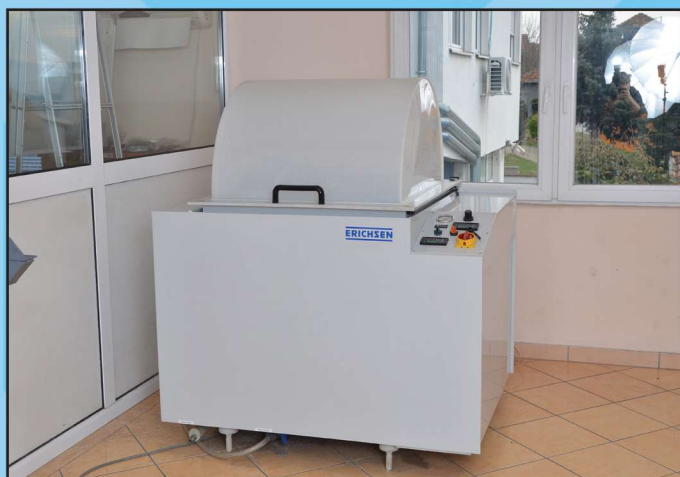
Uredjaj za ispitivanje korozijske postojnosti
