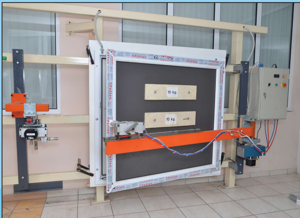
Uredjaj za ispitivanje okova
